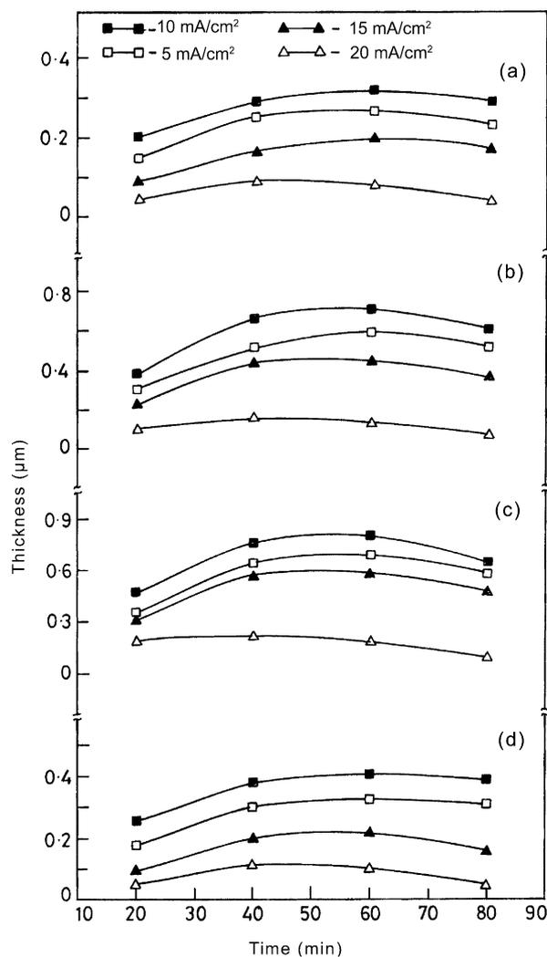
Fig. 2. Growth of WSe<sub>2</sub> thin films at: (a) 50 °C; (b) 60 °C; (c) 70 °C; (d) 80 °C.
